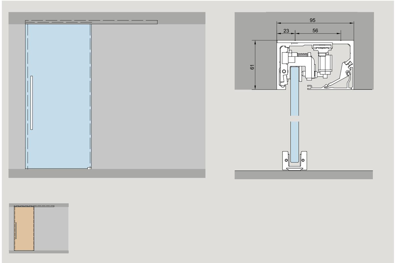
**Beispielansicht für MUTO Comfort L 80 Pocket, Tür (1- / 2-flügelig) und Seitenteil(e), eingelassen in Deckenschlitz**
