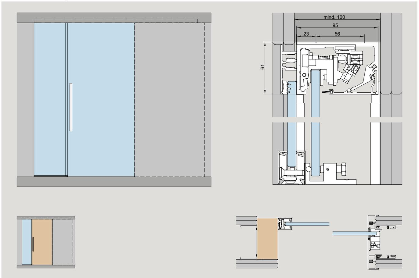
**Komplett-Sets für Glastür (8 - 13,5 mm, max 80 kg), Holztür (28 - 50 mm), 1- / 2-flügelig , mit und ohne Seitenteil, Einbau in Deckenschlitz**
