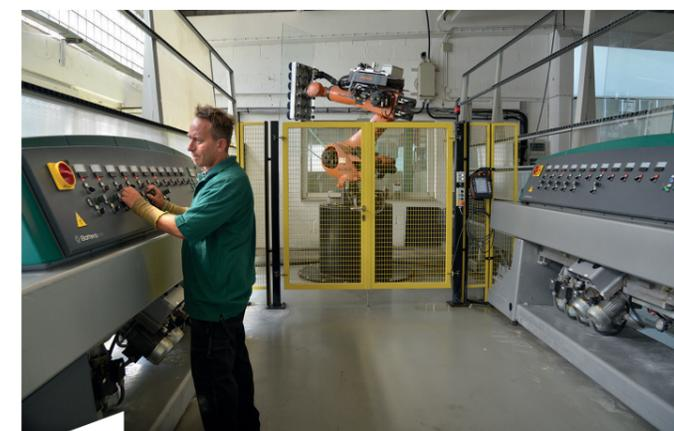
**Konsequente Automation: Ein Roboter versetzt die Scheiben an einem Schleifautomaten. Das verbessert den Durchsatz, ist rückschonend und trägt zur hohen Produktqualität bei.**
