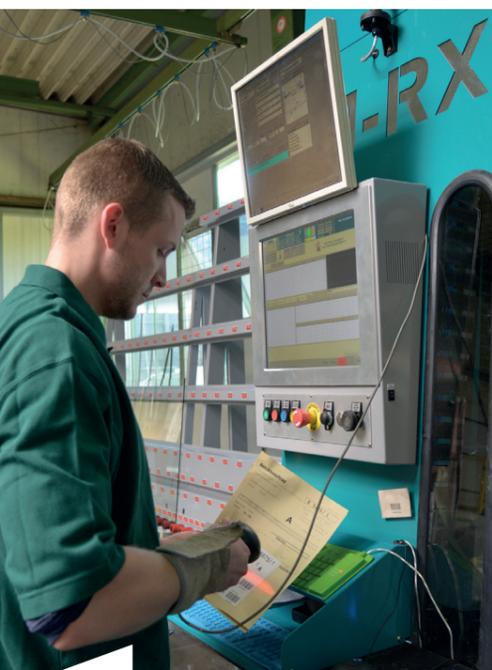
**Scan & Go: Mit einer Barcodelesung holt sich der Maschinenführer an der M-RX die Daten (Maße, Bearbeitungen) der aktuellen Scheibe auf den A+W Produktionsmonitor.**
