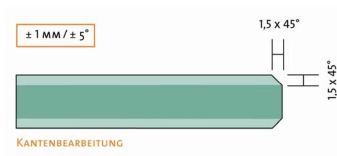
Die Diagonaltoleranz ergibt sich aus  $1,42 \times$  Rechtecktoleranz. (Bsp.: 2300 mm Kantenlänge daraus folgt  $1,42 \times 2,3 = 3,3$  mm  $\rightarrow$  3 mm Diagonaltoleranz)
