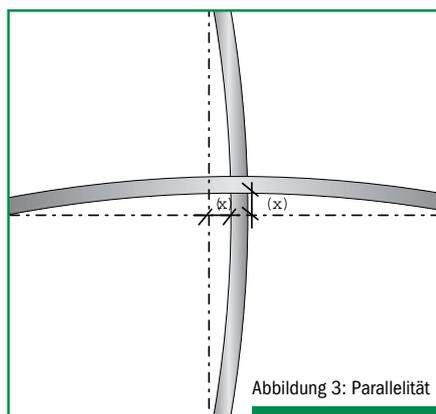
Die links genannten Toleranzen sind ohne Berücksichtigung der Fertigungs- und Einbautoleranzen des Isolierglases im Fenster sowie des Gesamteindruckes des Fensters einzuhalten. Bei Dreifach-Wärmedämmglas wird empfohlen, die Dekorsprossen auf den äußeren SZR zu begrenzen.
