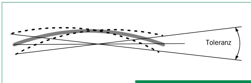
Nach maximaler Öffnung des Lamellensystems dürfen die Lamellen im mittleren Höhendrittel einer senkrechten Scheibe von der waagrecht nach der folgenden Tabelle abweichen:
